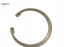
109471 securing ring DIN472 90x3 A2 Sicherungsring ø 90x3 DIN472 A2
