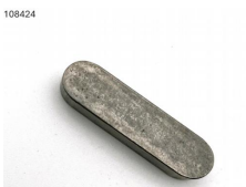
108424 feather key DIN 6885 A 10x8x40 Passfeder 10h9x 8h11x 40 DIN6885A C45K
