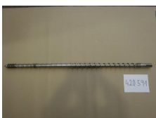
420591 screw Ø40 PMMA+HDPE (GCE 41) Schnecke Ø40 PMMA+HDPE (GCE 41)
