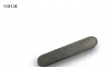
108158 feather key DIN 6885 A 8x7x40 Passfeder 8h9x 7h11x 40 DIN6885A C45K
