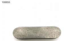
108855 feather key DIN 6885 A 16x10x63 Passfeder 16h9x 10h11x 63 DIN6885A C45K
