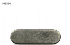
108866 feather key DIN 6885 A 6x4x20 Passfeder 6xh9 4h9x 20 DIN6885A C45K
