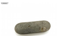
108667 feather key DIN 6885 A 16x10x50 Passfeder 16h9x 10h11x 50 DIN6885A C45K
