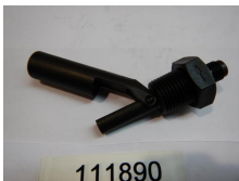
111890 floater Gew.-NPT-A/B-PA12 Klappschwimmerschalter Gew.-NPT-A/B-PA12 LVL 1/2NPT1Ao.1B0 250V/1A/50W
