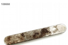
108668 feather key DIN 6885 A 16x10x110 Passfeder 16h9x 10h11x110 DIN6885A C45K
