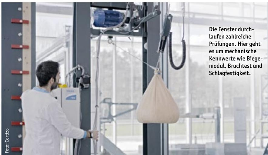
Die Fenster durchlaufen zahlreiche Prüfungen. Hier geht es um mechanische Kennwerte wie Biegemodul, Bruchtest und Schlagfestigkeit.
